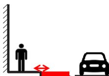
4. En cas de paroi ou de cloison, limiter la hauteur à 110 cm et la placer à minimum 20 cm du pourtour du plancher ;
