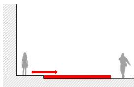
3. Fixer les panneaux vitrés au moyen d'une bordure périphérie type socle d'une hauteur de maximum 20 cm ;
